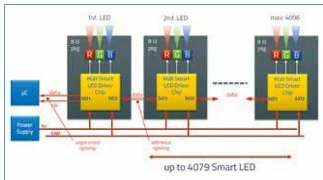
圖片 2: 由單片機 (MCU) 至第一顆SELED模組是五伏單端點的訊號傳輸。隨後是差分的訊號可串聯起後續的燈泡。
